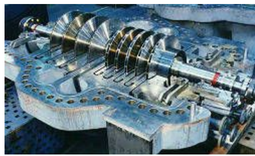
Центробежный компрессор с разъемом в горизонтальной плоскости
